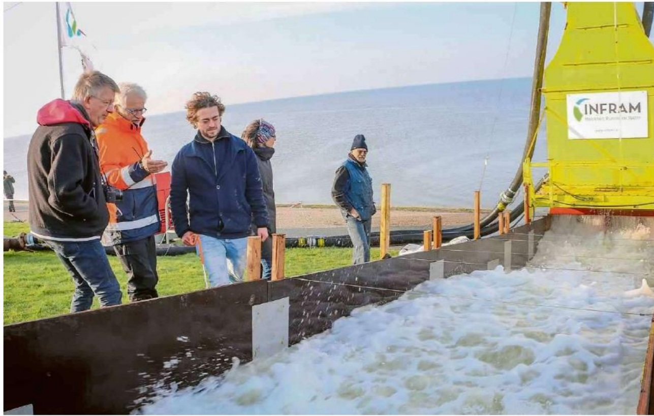
De gele simulator van Infram bootst golven van soms wel twee meter na. Met deze golfoploopproof wordt de grasmat van de zeedijk getest. Eerder gebeurde dit al in Finsterwolde en de Eemshaven in Groningen. Foto: Jan Ligthart
