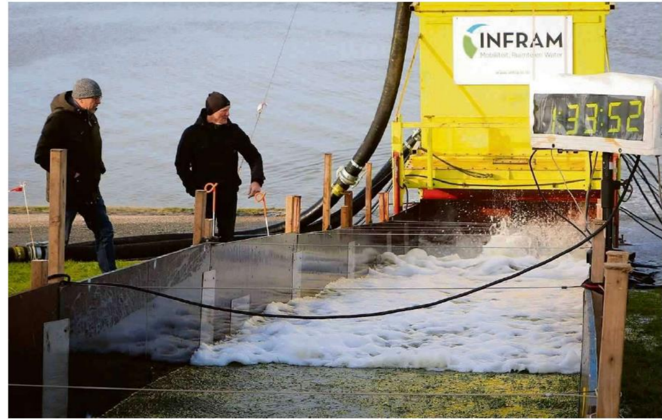
De gele simulator van Infram bootst golven van soms wel twee meter na. Met deze golfoploopproof wordt de grasmat van de zeedijk getest. Eerder gebeurde dit al in Finsterwolde en de Eemshaven in Groningen. Foto: Jan Ligthart
