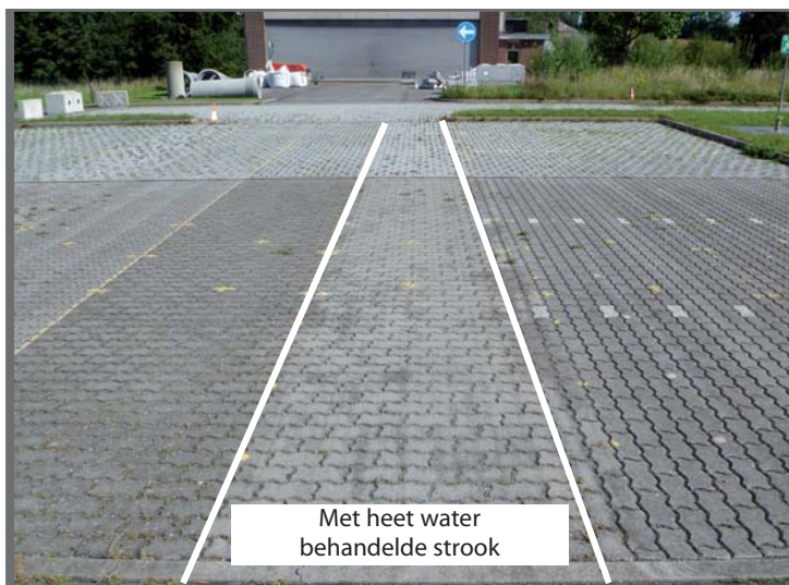
Figuur 4.22 Effect van heetwaterbehandelingen op de helderheid van straatstenen. Visuele vergelijking met foto, genomen op 4 augustus 2011.
